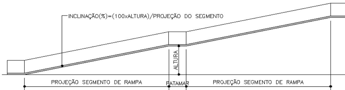
RAMPA – CORTE ESQUEMÁTICO
